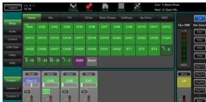
L'enregistrement multipiste d'un spectacle live utilise généralement les départs d'insert des canaux pour ne pas être affecté par le mixage live. Vous pouvez changer cela en faveur des sorties directes pour un enregistrement en studio et d'autres applications.
