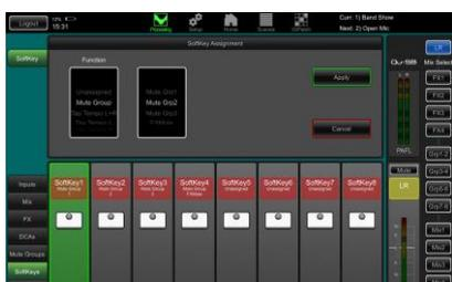
**Brancher des systèmes de retour optionnels ME-1** – Allez dans l'onglet Monitor de la page **I/O Patch** pour raccorder les sorties du mixeur Qu aux 40 départs ME-1. En général, on envoie les sorties directes des canaux d'entrée. La sortie directe recommandée est post-delay, pré-fader, post-Mute.
