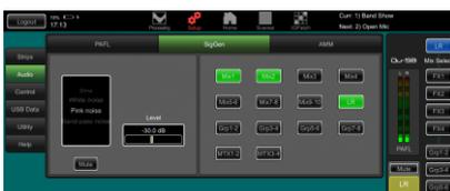
**Générateur de signal (SigGen)** – Le mixeur Qu intègre un générateur de signal. Le bruit rose est une excellente source pour tester les enceintes. Il génère une énergie égale par octave sur toutes les fréquences et peut servir à vérifier que tous les haut-parleurs des enceintes fonctionnent et à repérer les problèmes de phase et de polarité.
