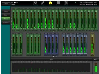
**RTA** – L'analyseur en temps réel (RTA) intégré fournit un affichage utile de la réponse en fréquence du signal PAFL actuellement sélectionné. Cela peut aider à trouver les fréquences à problème dans une salle ou bien à filtrer les retours contre les larsens.
