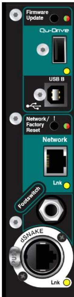
**1 Network (port réseau)** – Le Qu-SB se contrôle à l'aide d'un iPad exécutant l'appli Qu-Pad d'Allen & Heath. Connectez un routeur sans fil (point d'accès sans fil) à ce port pour configurer un réseau Wi-Fi permettant à l'iPad de se connecter au mixeur. Cela sera décrit plus en détail dans ce guide.
